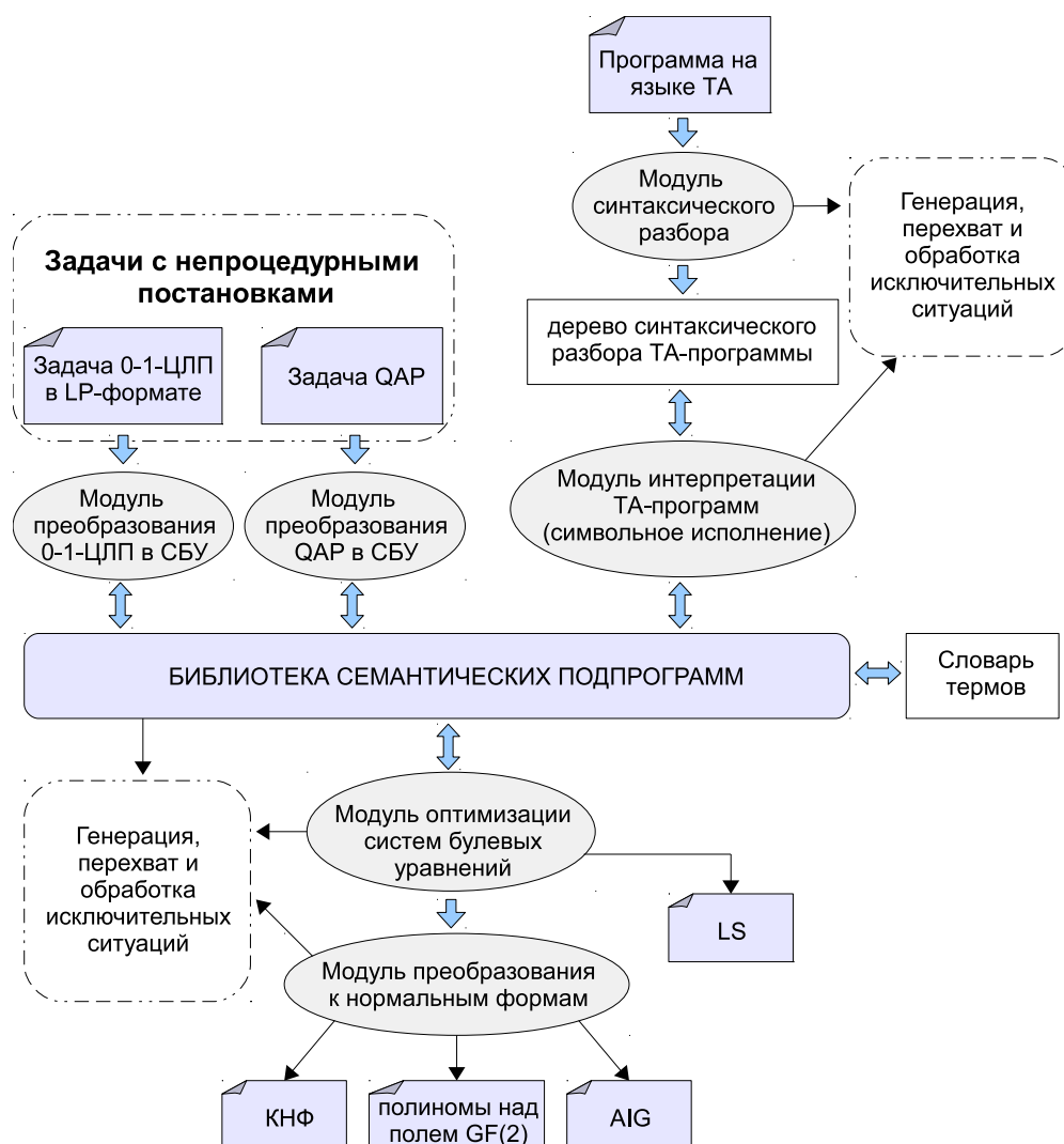
Рис. 2.7. Архитектура программного комплекса Transalg.
